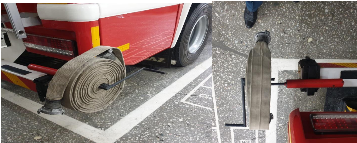
Рис. 1. Опытный образец быстросъемного технического устройства для скатки напорных рукавов (установлен на задний бампер автоцистерны АЦ-3,2-40/4 КАМАЗ 5387 с пожарной надстройкой «Rosenbauer»)
