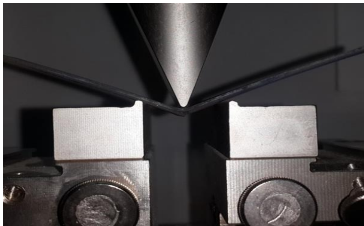
Рис. 1. Испытание образца с покрытием ПГСП-2 на 3-х точечный изгиб
