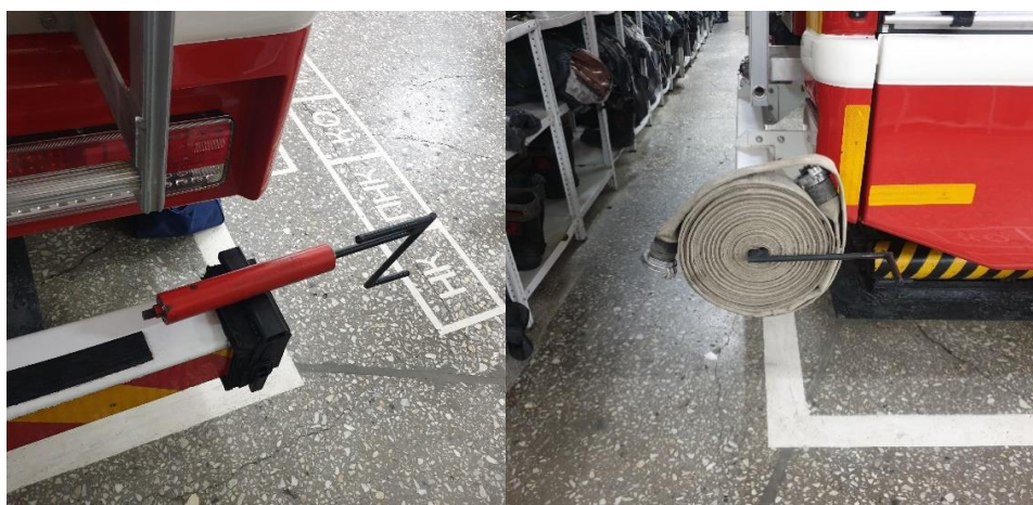
Рис. 4. Опытный образец быстросъемного технического устройства (установлен на задний бампер автоцистерны АЦ-3,2-40/4 КАМАЗ 5387 с пожарной надстройкой «Rosenbauer»)
