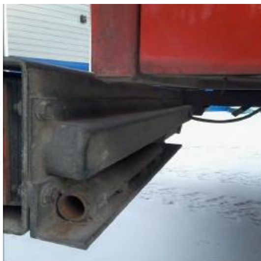
Рис. 3. Изменение конструктивного оформления заднего бампера пожарной автоцистерны, путем приваривания усиливающего уголка и трубы
