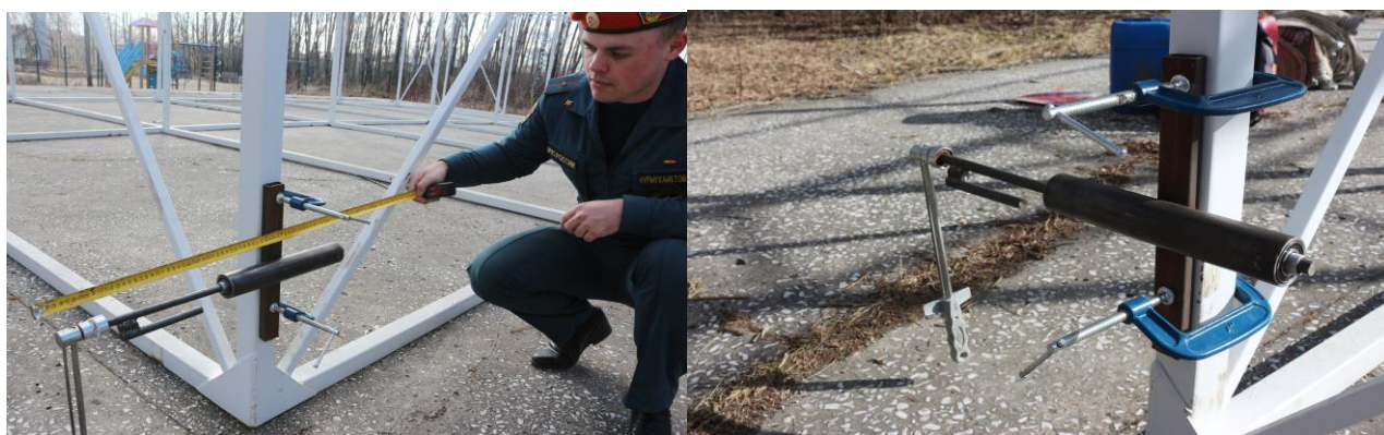
Рис. 4. Моделирование высотного расположения опытного образца с помощью фиксирующих струбцин
